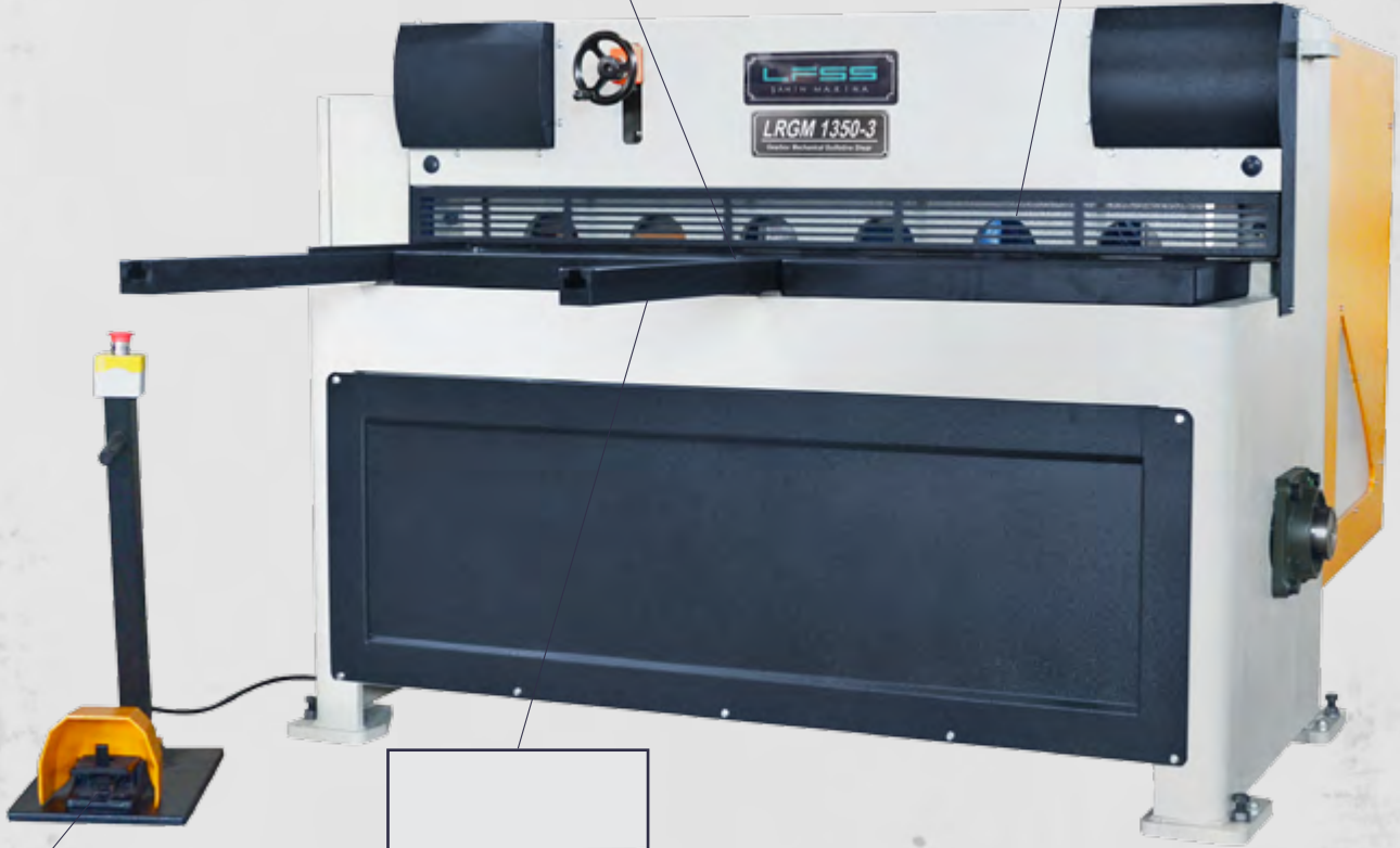
Bilyalı Ön Tabla Ball-bearing Front Table
